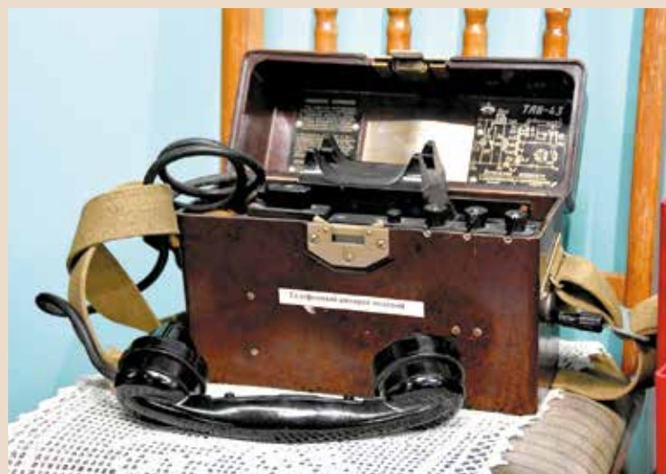
Телефонный аппарат с индукторным вызовом (ТАИ-43) образца 1943 года
