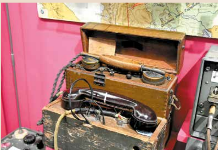
Унифицированные телефонные аппараты (фонические) УНА-Ф-28 (1928 год) и УНА-Ф-42М (1942 год)
