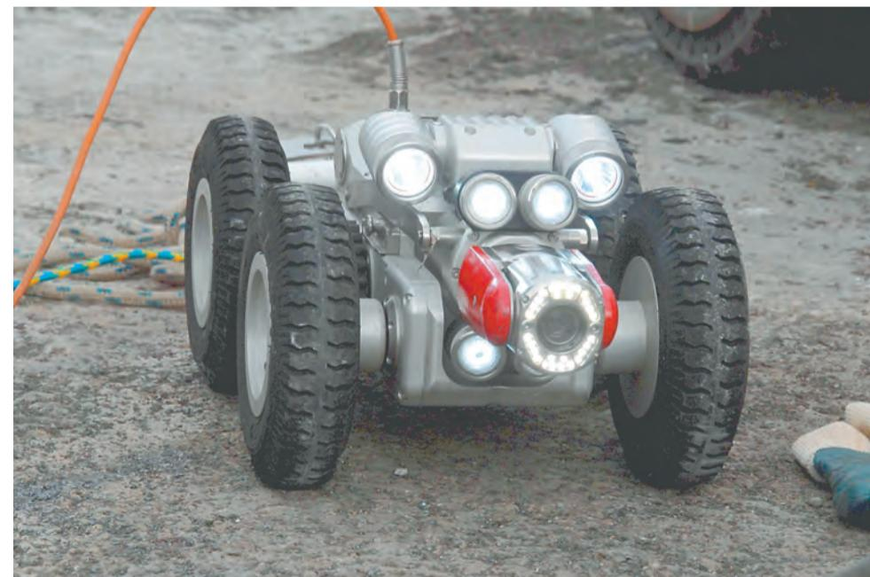
Для обследования канализационных коллекторов большого диаметра используется робот на движущейся платформе. В этом сезоне, например, в Кировском и Дзержинском районах планируется определить техническое состояние нескольких железобетонных и керамических коллекторов разных диаметров (от 300 до 1500 мм), проложенных в 1960–1980-х годах.
