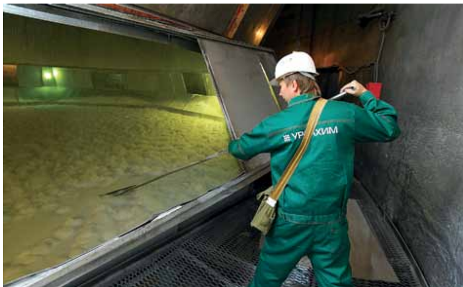
Охлаждение гранул карбамида на «кипящем слое»
